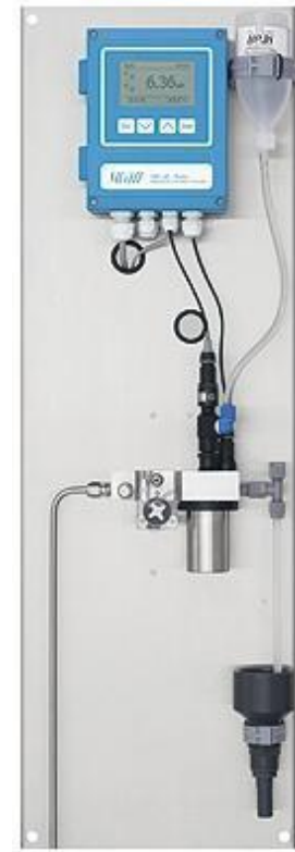
SWAN Monitor AMI pH SI (elektroda Swansensor pH SI)
